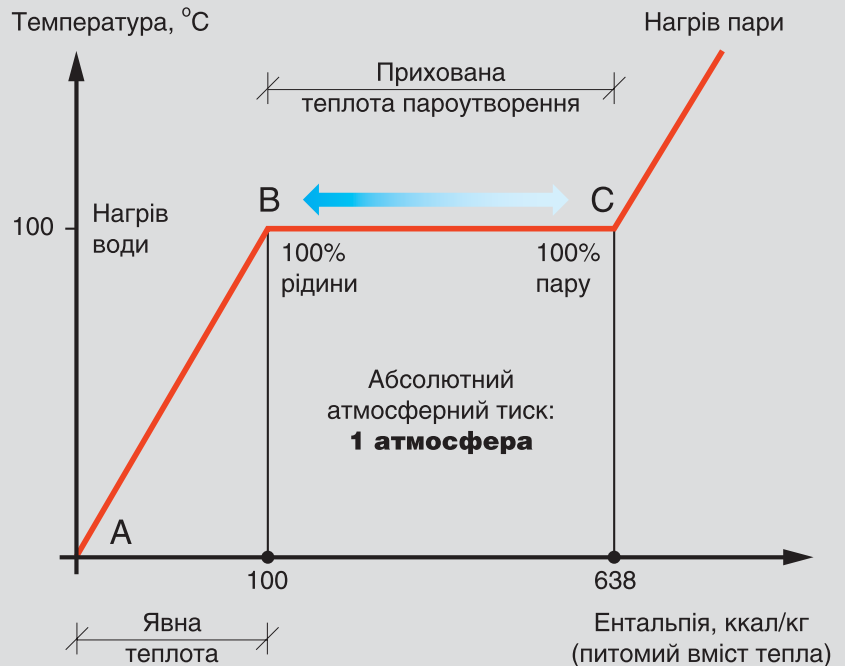
Рис. 1: Залежність температури від ентальпії води при пароутворення/конденсації
