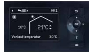
Display der Regelung Vitotronic 200 (Typ W01C)
