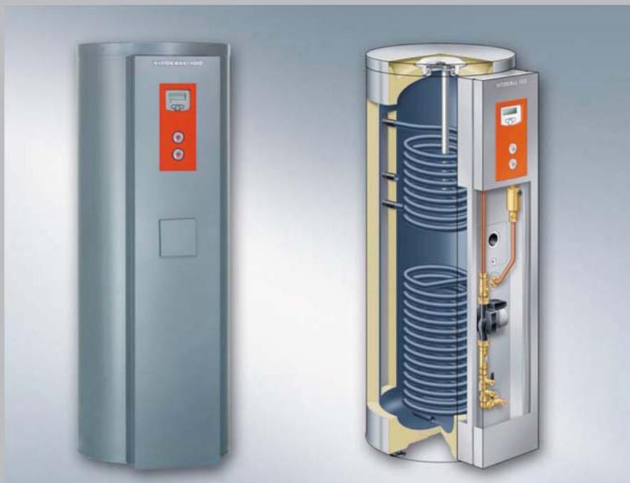
**Рис. 29.** Vitocell 100-U – работающий от двух источников тепла емкостной водонагреватель с встроенным циркуляционным насосом, смонтированной системой труб гелиоконтура, арматурой для наполнения, воздухоотводчиком и автоматикой управления Vitosolic 100
