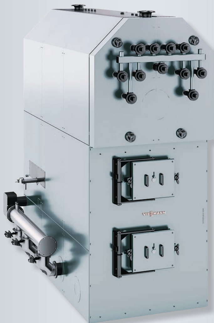
Vitoflex 300-VF – Твердопаливний котел з плоскою рухомою колосниковою решіткою та гідравлічною системою прямої подачі палива в камеру згорання
